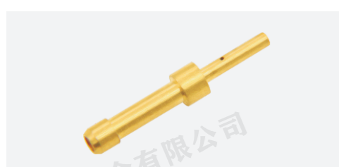
CFCZ-009 类别: 插针系列 名称: 插针端子 尺寸: \Phi 2 \times 16 材质: 铜材H59
