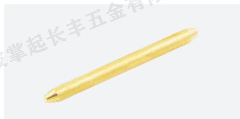
CFCZ-003 类别: 插针系列 名称: 插针端子 尺寸: \Phi 1.3 \times 15 材质: 铜材H59
