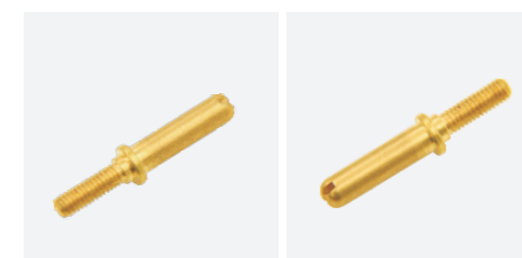
CFCZ-014 类别: 插针系列 名称: 插针端子 尺寸: \Phi 4.5 \times 22 材质: 铜材H59
